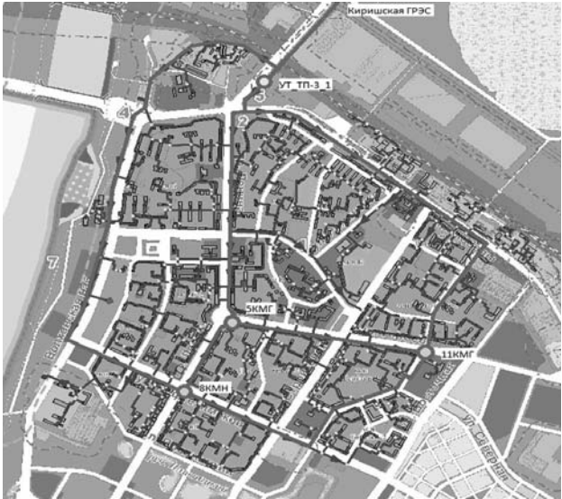
Рисунок 26 - Магистральные тепловые сети
